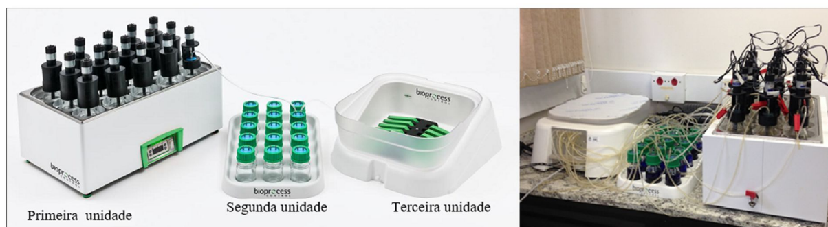
Figura 1- Equipamento AMPTS II - Unidade de incubação; Unidade de fixação do CO 2 ; Unidade de medição de metano.
