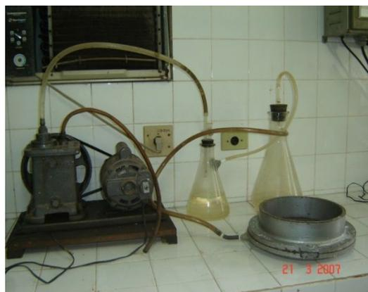
Figura 2 – Filtro a vácuo Primar (deslocamento de 48 L/min) com dois kitassatos acoplados em seqüência, e um filtro a vácuo de tela metálica B8A Denver Lab Filter.
