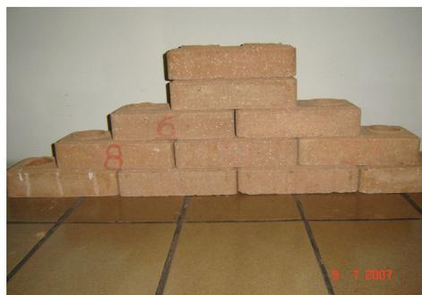
Figura 6 - Encaixe e montagem da alvenaria não estrutural
