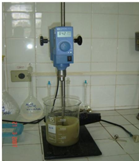
Figura 1 – Agitador eletrônico Ika-Werke, modelo Eurostar digital, para líquidos semi-viscosos
