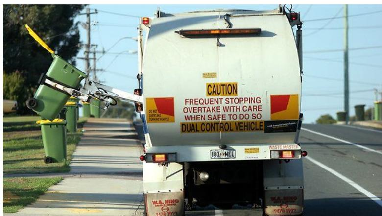
Figura 7: Coleta mecanizada dos bins. Fonte: AUSTRÁLIA, 2018.
