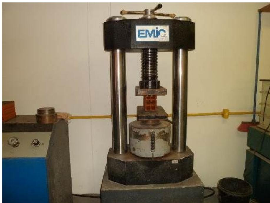
Figura 5: Ensaio de resistência mecânica à compressão. Fonte: Autor do Trabalho.
