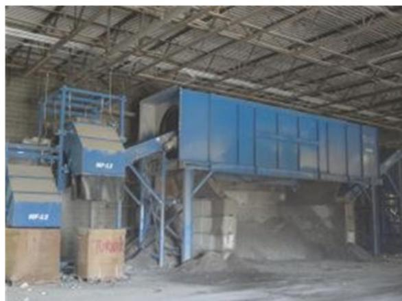
**Figura 8:** *Trommel* (peneira rotativa) para separação granulométrica dos resíduos triturados no *Shredder*.
