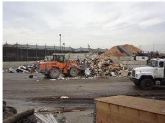
**Figura 4: Carregadeira na triagem prévia em pátio de recebimento de RCD.**
