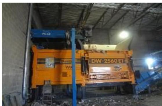
**Figura 7:** *Shredder* (triturador) de resíduos não separados manualmente na esteira.
