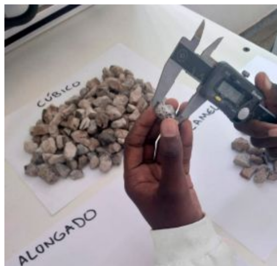
Figura 03: Medição dos agregados para determinação da forma dos grãos. Fonte: Autor do trabalho.
