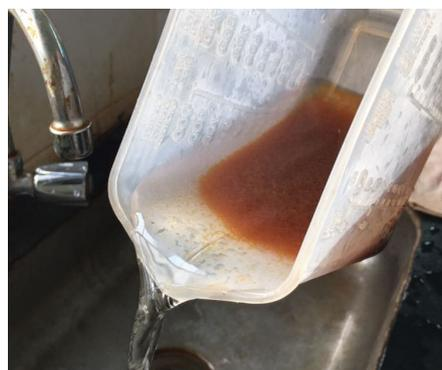
**Figura 7: Lodo de ETA. Destaca-se o elevado teor de sólidos. Fonte: SOARES e SILVA, 2017.**
