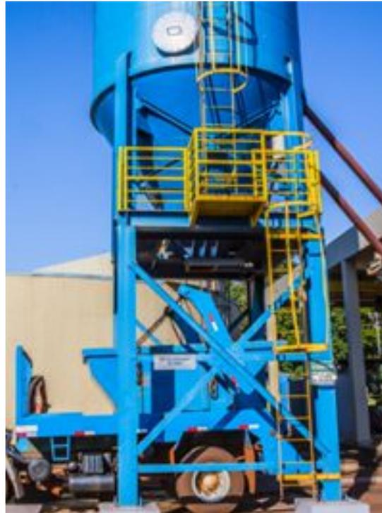
Figura 3: Armazenamento de LETE desaguado em Silos. Fonte: Autores, 2017.
