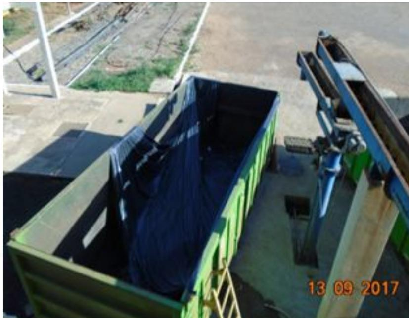
Figura 4: Carregamento Mecanizado das Cacambas com LETE desaguado. Fonte: Autores, 2017.
