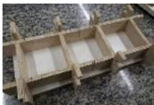
Figura 1: Fôrmas para molde das peças cimentícias. Fonte: Autores.
