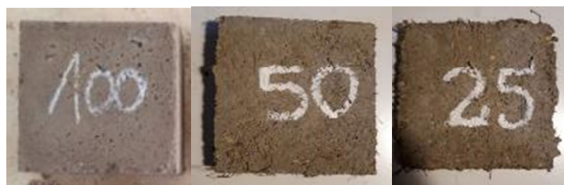
Figura 3: Placas cimentícias desenformadas e secas. Fonte: Autores.
