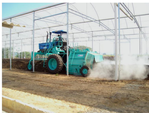
Figura 1: Processo de compostagem do lodo de esgoto. Foto: Fernando Lourenço de Oliveira.
