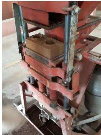
**Figura 03- Prensa hidráulica para tijolo solo cimento. Fonte: os autores.**
