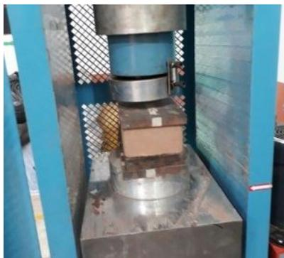
**Figura 04- Prensa hidráulica para teste de resistência compressão. Fonte: os autores.**
