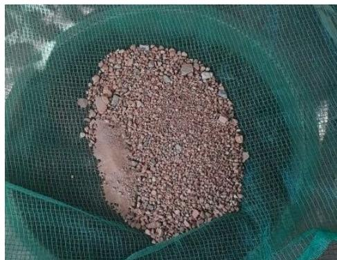
**Figura 03 - Processo de Trituramento dos resíduos. Fonte: os autores**
