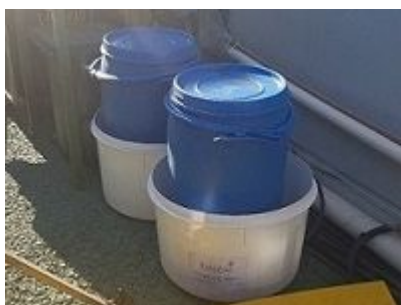
Figura 1: Uso correto das bombonas com os devidos contentores
