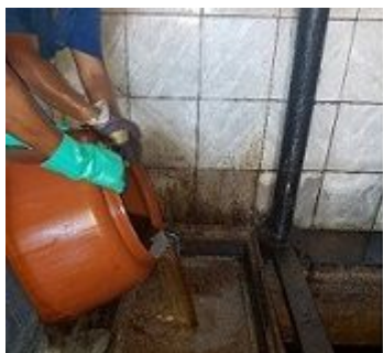
Figura 3: Tanque de transbordo do óleo e sistema de peneira (A) e tanque de resíduos não aproveitáveis (B).
