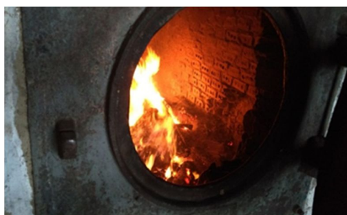
Figura 3: caldeira sendo movida por resíduos da castanha. Fonte: Autor do Trabalho.
