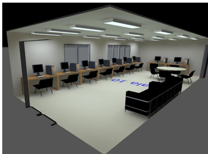
Figura 6: Modelo da sala de estudos 1 pelo software DIALux evo. Fonte: Autor do Trabalho.
