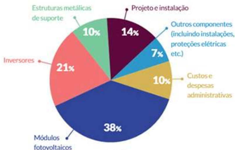
Figura 10: Composição típica de um sistema fotovoltaico. Fonte: IDEAL (2018).
