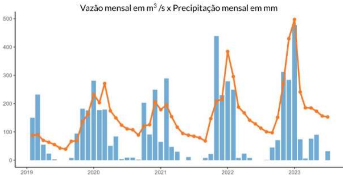
Figura 10 – Relação entre vazão e precipitação na bacia Rio do Prata no período de 2019 a 2023.
