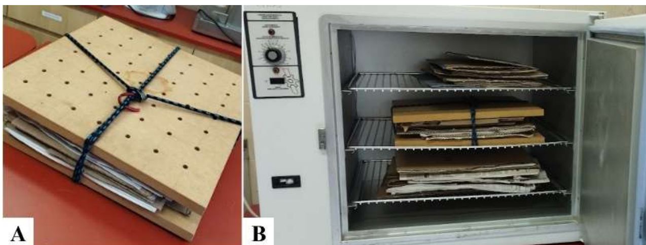
Figura 04: Plantas no Laboratório de Recursos Naturais - Universidade Federal do Rio Grande - FURG. Onde: (A) prensa de espécies vegetais e (B) estufa de secagem. Fonte Autoras, 2023.
