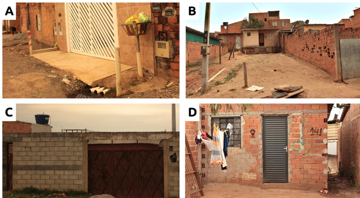
**Figura 4: Fachadas de unidades habitacionais da comunidade – A: Fachada com portão e calçamento com despejo de águas cinzas diretamente na via; B: Fachada sem portão com encanamento de ligação; C: Fachada com portão sem despejo na via; D: Fachada sem portão sem despejo na via. Fonte: Arquivo pessoal (2019).**
