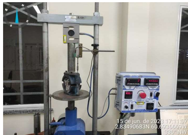
(f) Prensa computadorizada – Estabilidade e tração
