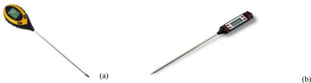
Figura 2 – Equipamentos utilizados para medição dos parâmetros acompanhados: (a) Medidor PHD-3000, (b) HM-e 600
