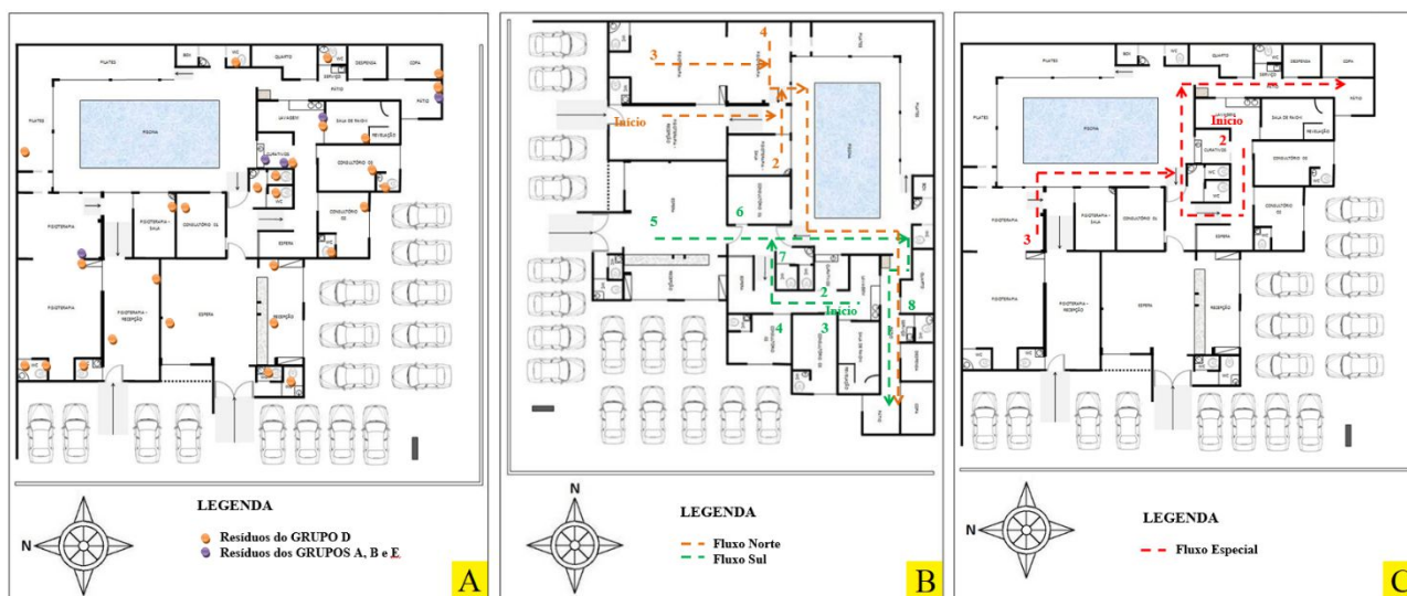
Figura 1 – Planos de coleta de resíduos (sugeridos e criados pelo estagiário). A) Plano de localização dos coletores de resíduos dos diferentes grupos; B) Plano de coleta dos resíduos do Grupo D; C) Plano de coleta de resíduos dos demais Grupos A, B e E.
