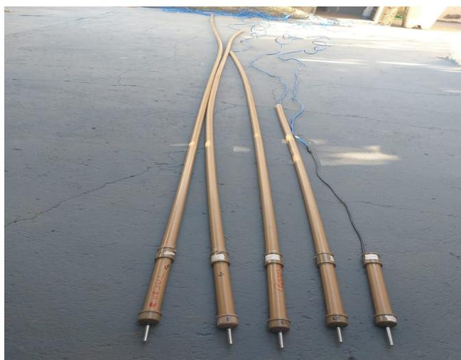
**Figura 3: Complemento das Ponteiros - Conexão dos Sensores de Temperatura DS18B20 ao Cabo CAT-6 TZ6 e aos Tubos de PVC. Fonte: Autor do trabalho.**
