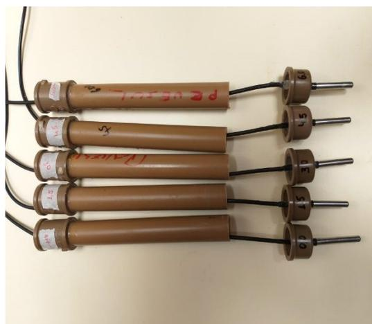
**Figura 2: Preparação das ponteiros. União do cap soldável ao tubo de 20 centímetros e a rosca soldável de PVC.**
