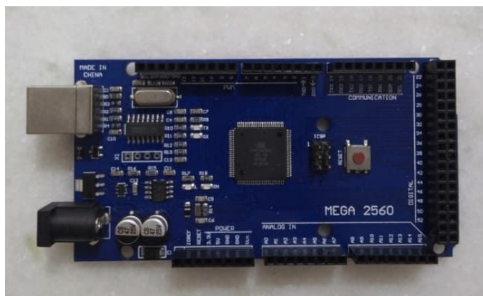
Figura 4: Arduino Mega 2560 R3. Fonte: Autor do Trabalho.
