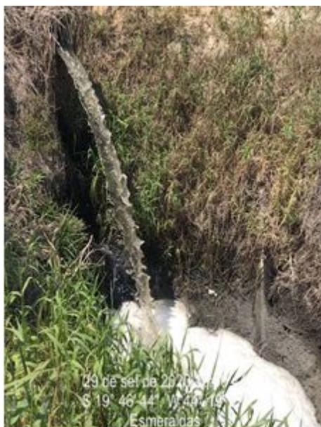
**Figura 2 – Ponto de lançamento dos efluentes da ETE Esmeraldas no Ribeirão Filipão. Fonte: Autores do trabalho.**
