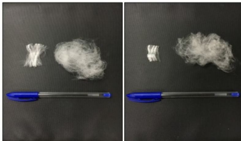
Figura 2: Fibras de PET de 3,3 dtex com 56mm e 1,4 dtex com 38mm. Fonte: Senez (2016).
