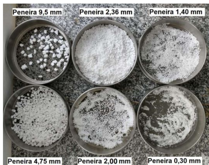
Figura 4: Partículas do resíduo de poliestireno expandido retidas em cada peneira. Fonte: Arquivo pessoal (2021).
