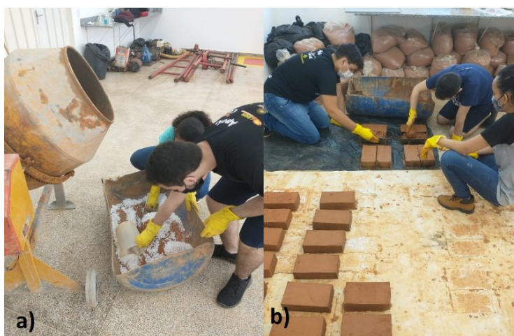
Figura 2: Etapas do procedimento de confecção dos blocos: (a) mistura prévia de solo, cimento e resíduo de EPS; (b) moldagem dos blocos. Fonte: Arquivo pessoal (2021).
