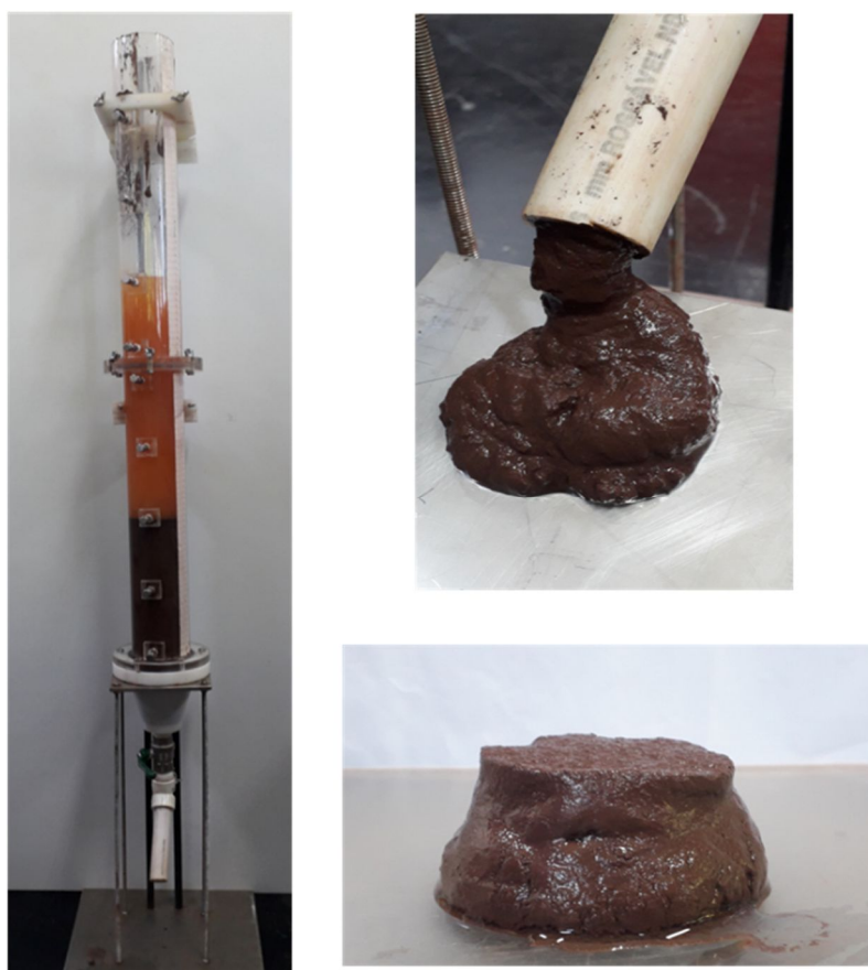
Figura 3. Ensaio de espessamento e teste de abatimento para o rejeito de minério de ferro com 120 g/t Mag 5250.
