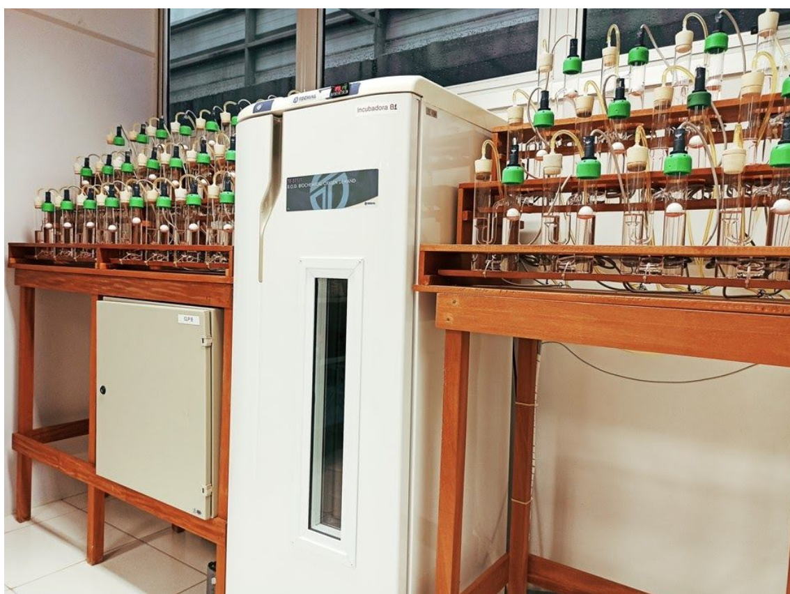
Figura 2- Incubadora bacteriológica e Sistema Automatizado de Medição de Biogás - SAMB. Fonte: CPETS - Centro de Pesquisa em Energias e Tecnologias Sustentáveis.
