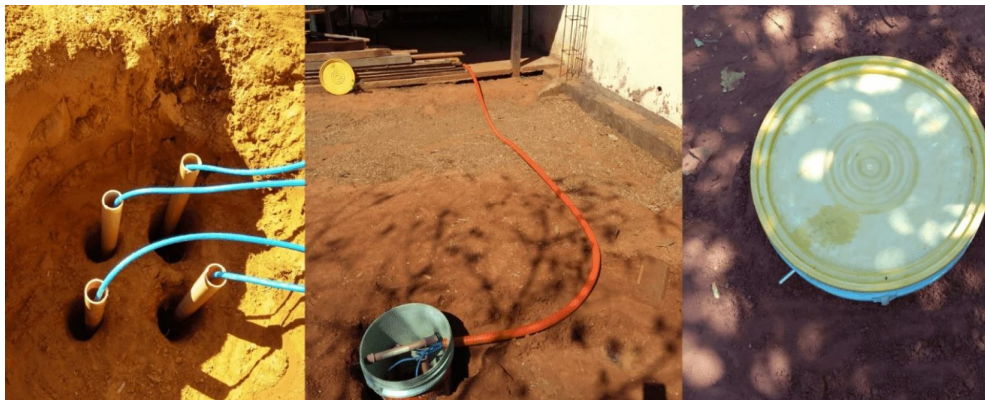
Figura 7: Etapas de inserção e vedação dos sensores no solo de Ouro Verde - SP. Fonte: Autor do Trabalho.
