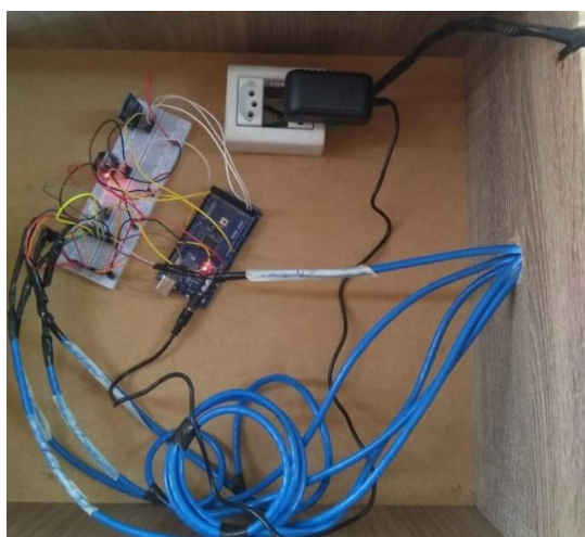
Figura 8: Disposição final dos sensores no Arduino. Fonte: Autor do Trabalho.
