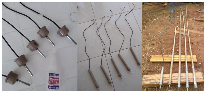
Figura 6: Etapas de preparo dos sensores, do início ao fim, para inserção no subsolo. Fonte: Autor do Trabalho.
