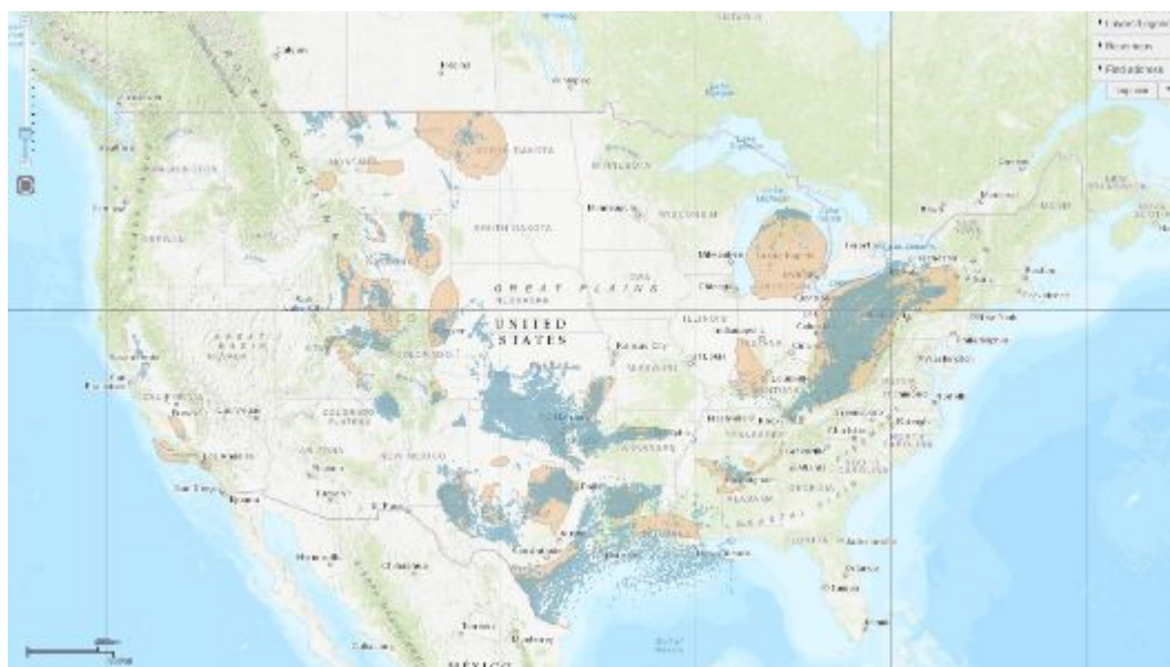
Figura 5: Sistema de mapeamento de energia dos EUA – reservas de gás de xisto (rosa) e poços de produção de gás (azul)
