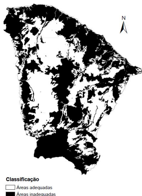
Figura 3 – Áreas adequadas para instalações do tipo PV em grande escala no estado do Ceará. Fonte: Autor do Trabalho.
