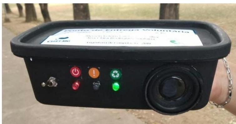
**Figura 4: Dispositivo Medidor de Nível de Resíduos. Fonte: Autores do Trabalho.**
