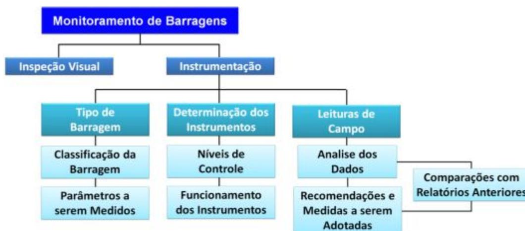
**Figura 4: Processo de monitoramento de barragens por instrumentação. Fonte: Oliveira (2019).**
