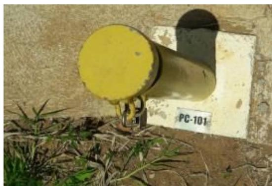
Figura 3: Piezômetro Casagrande. Fonte: Oliveira (2019)
