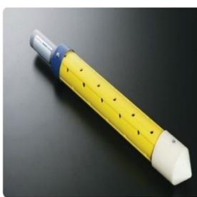
(C) Piezômetro de Casagrande
