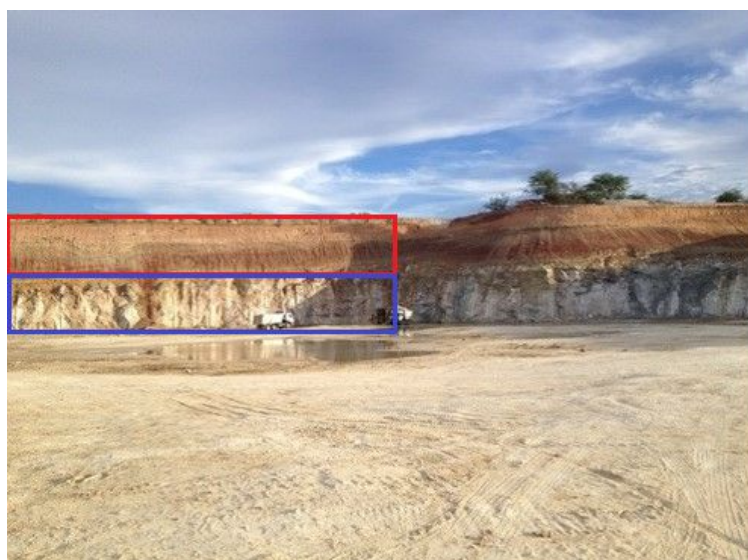
Figura 4: Comparação das espessuras do capeamento de argilominerais e do corpo mineralizado de gipsita
