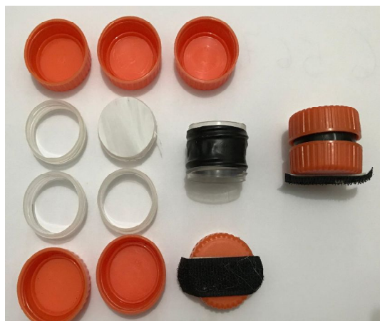
Figura 01: Amostrador passivo confeccionado para pesquisa Fonte: Autora do trabalho
