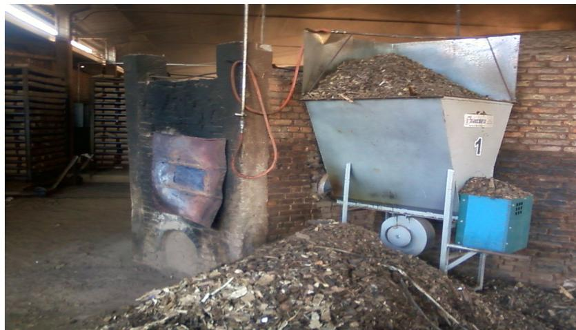
**Figura 1: Dosador mecânico de cavaco de madeira do forno. Fonte: Autor do trabalho.**
