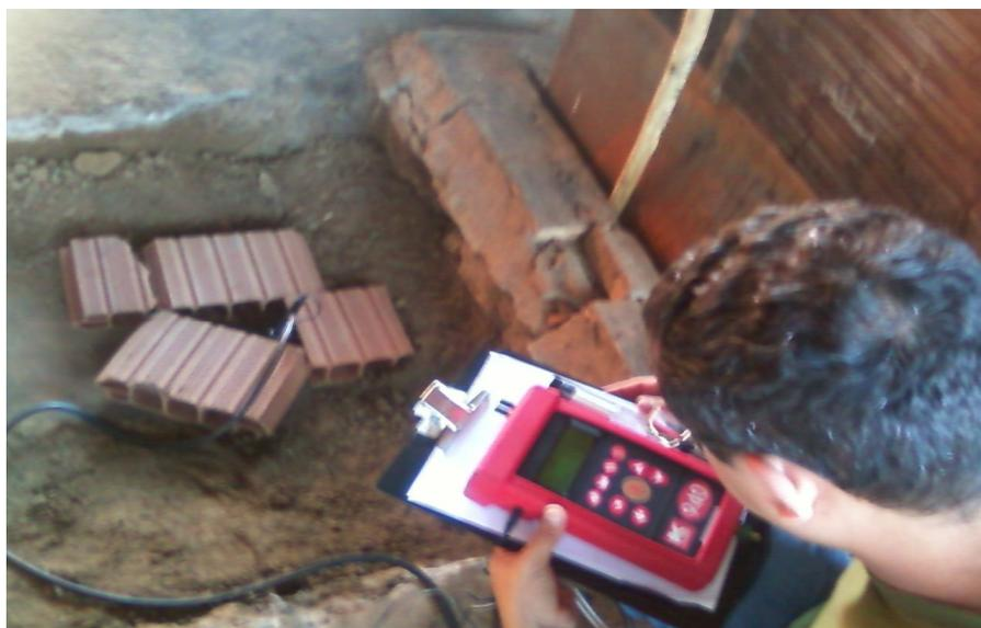
**Figura 2. Medição dos gases emitidos na queima dos blocos cerâmicos. Fonte: Autor do trabalho.**
