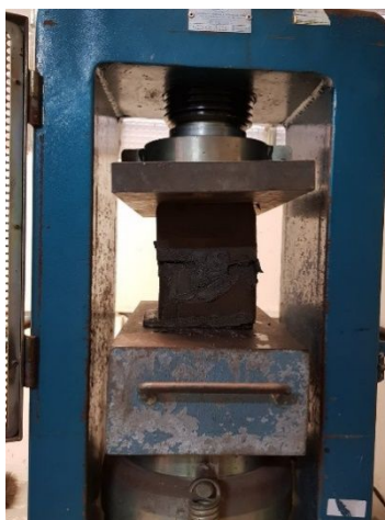
Figura 4: Ensaio de resistência à compressão. Fonte: Autor do Trabalho.
