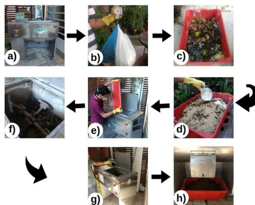
**Figura 01: Etapas do processo de compostagem acelerada. Fonte: Elaborado pelos autores.**
