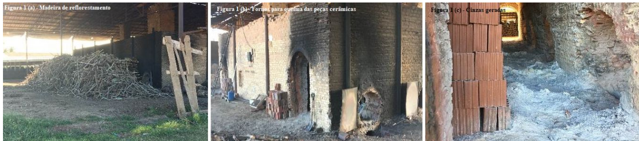
Figura 1: Processo de queima e geração da cinza de olaria. Fonte: Autores do trabalho.
