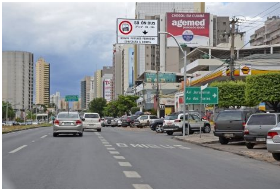
FIGURA 03 – Sinalização da faixa exclusiva para ônibus. Foto: Nathalia Ferreira Miranda
