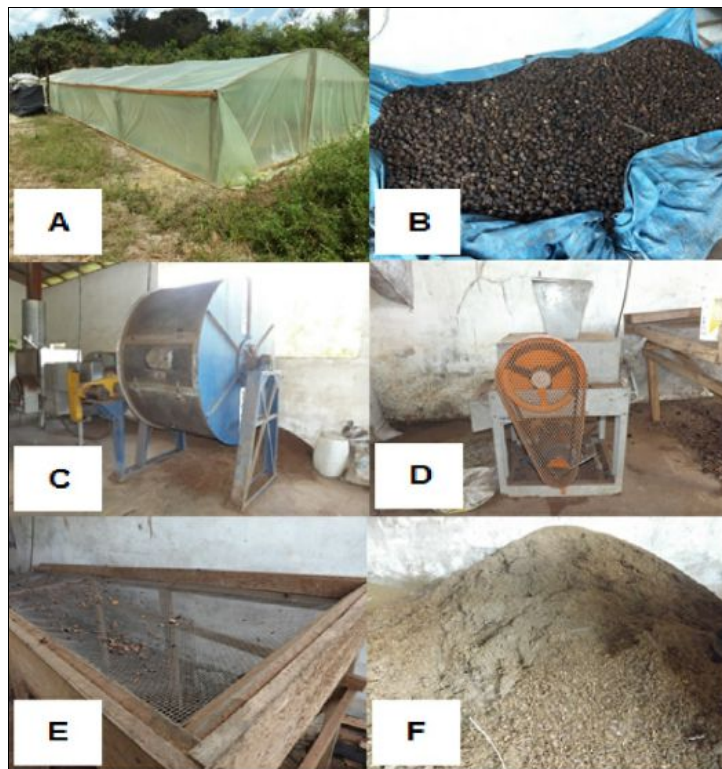
Figura 1- Procedimentos do beneficiamento da matéria prima: A) Estocagem em estufa; B) Matéria prima andiroba ( Carapa guianensis ) e outras sementes; C) Secagem; D) Triturador; E) Peneira e F) Resíduo. Fonte: Autor, 2018.
