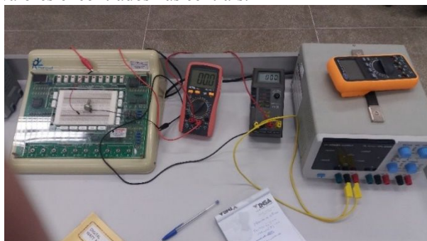
Figura 3 - Quantificação das variáveis, tensão, corrente e potência.
