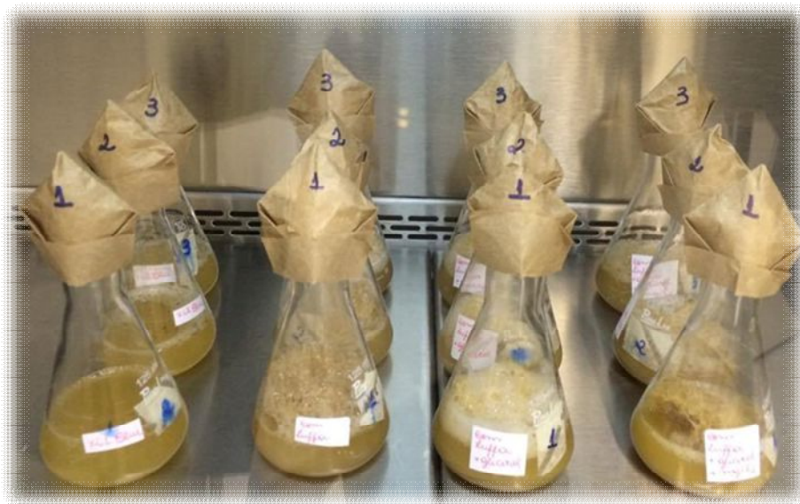
Figura 4 - Cultivos para avaliação da influência Luffa cylindrica tratada e da suplementação do meio. Erlenmeyers a esquerda - Cultivo sem Luffa cylindrica e sem suplementação, seguidos dos cultivos com Luffa cylindrica sem tratamento e sem suplementação, com Luffa cylindrica tratada e meio suplementado com glicerol 30 mM e com Luffa cylindrica tratada e meio suplementado com glicerol 30 mM e MgCl 2 10 mM.
