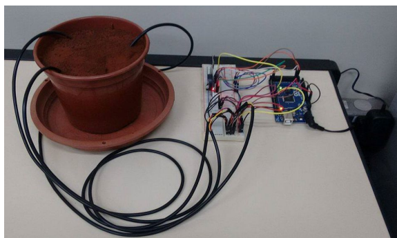
Figura 1 - Protótipo para verificação da precisão dos sensores. Fonte: Própria.
