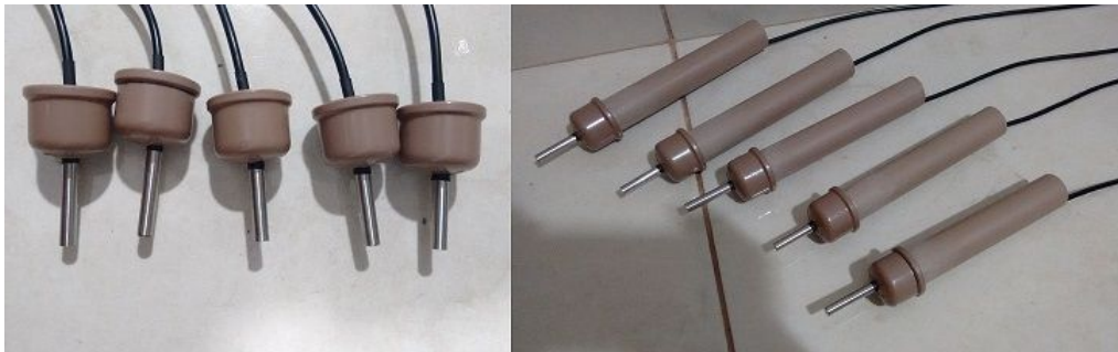
Figura 5 - Preparação das ponteiros dos sensores. Fonte: Própria.
