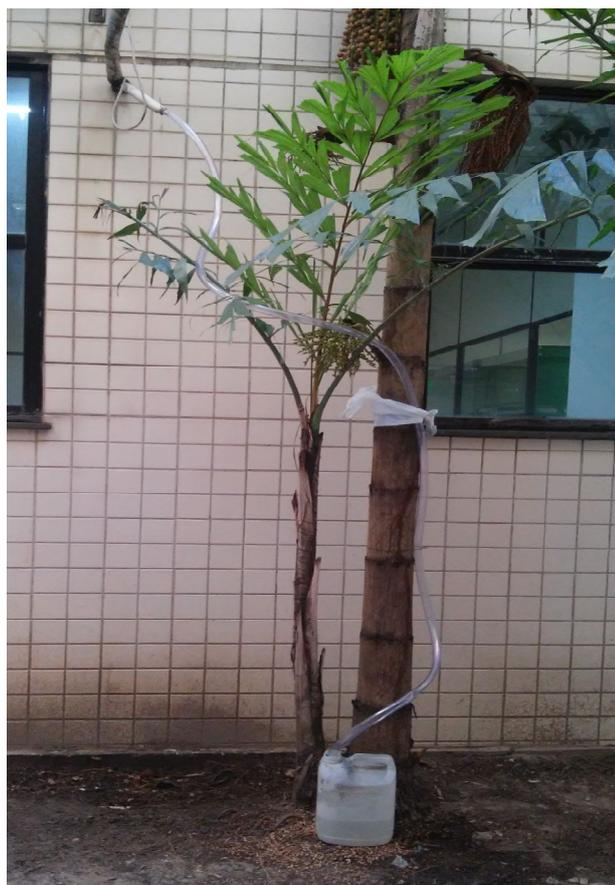
Figura 3: Coleta para medição da vazão de água dos condicionadores de ar do tipo *Split*. Fonte: Autores.
