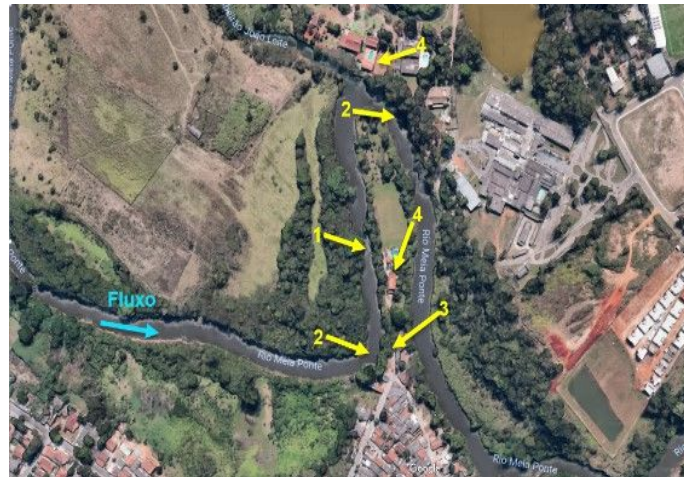
Figura 3 – Ponto 2: Imagem evidenciando pontos de sedimentação (1), erosão das margens (2), ponto de possível alteração do canal (3) e ocupação urbana em área relacionada ao sistema fluvial (4).
