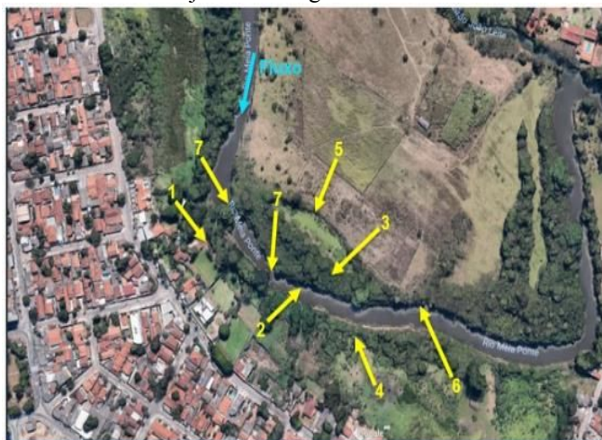
Figura. 02- Ponto 1: Imagem evidenciado ocupação sobre a planície de inundação/dique marginal (1), sedimentos em suspensão (2), planície de inundação com (3) e sem vegetação (4), desnível entre terraço e planície de inundação (5), erosão na margem esquerda (6) e estreitamento do canal (7).
