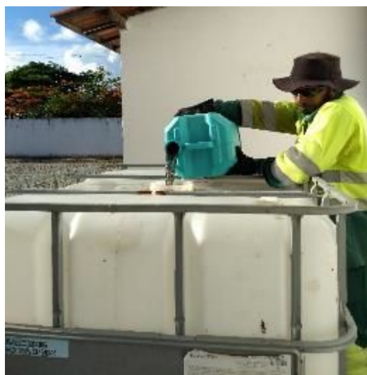
Figura 1: Aplicação do biopolímero na estação de tratamento pelo operador.
