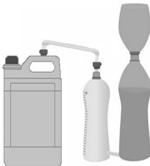
Figura 1: Biodigestor e medidor de biogás. Fonte: Autor do Trabalho.
