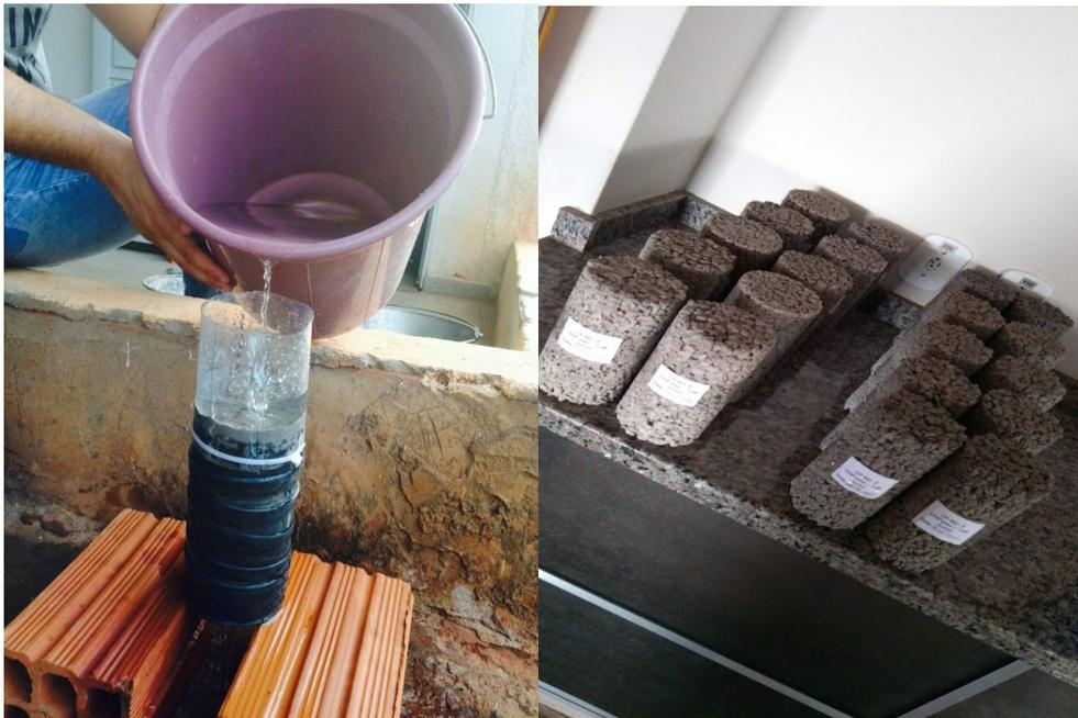
**Figura 2 e 3: Ensaio com o permeâmetro desenvolvido e corpos de prova usados no ensaio. Fonte: Autor do trabalho.**
