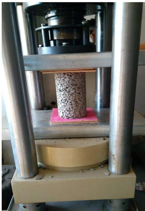
**Figura 1: Ensaio de compressão axial com capeamento de madeirite. Fonte: Autor do trabalho.**
